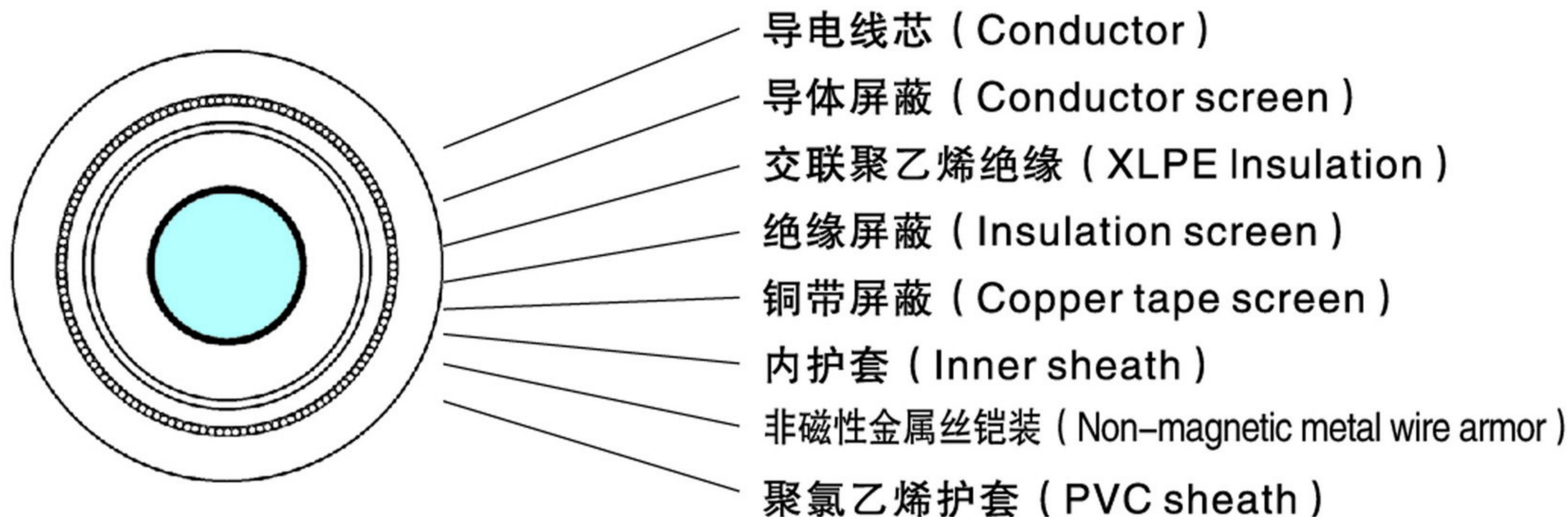
YJV72-18/20kV、18/30kV单芯非磁性金属丝铠装电力电缆 18/20kV、18/30kV single core Non-magnetic metal wire armor power cable
