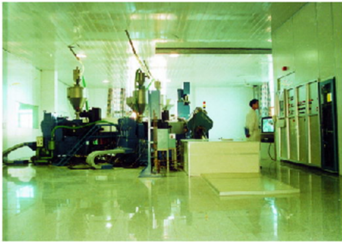
引进芬兰诺基亚公司110kV及以下交联生产线 110kV CDCC line imported from NOKIA
